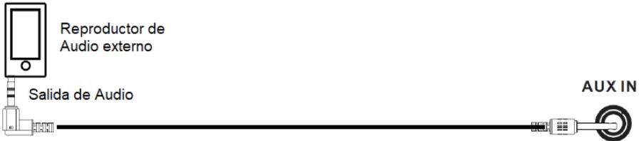
1. Conectar la salida del dispositivo de audio externo al conector de entrada auxiliar de Ø3.5 mm de la barra de sonido a través del cable auxiliar incluido.
