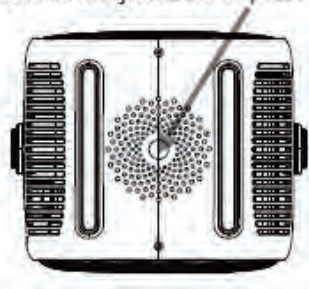
Orificio de fijación del soporte
